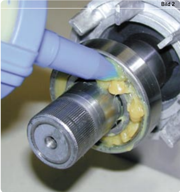
Schmieren eines Rillenkugellagers auf der Rotorwelle
