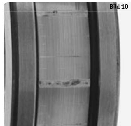
Verschleiß in einem Zylinderrollenlager infolge von Schwingungen im Stillstand
