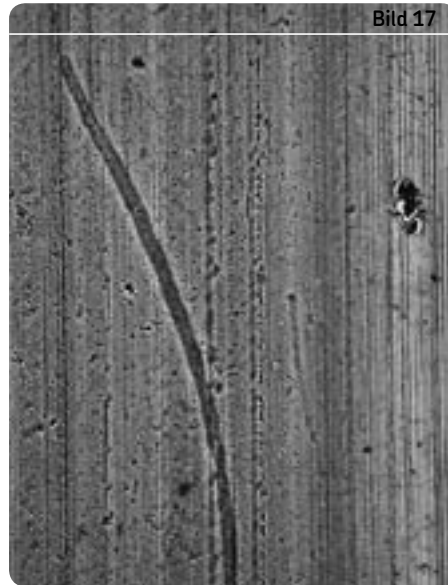
Eindrückungen in einer Laufbahn durch überrollte Fremdpartikel
