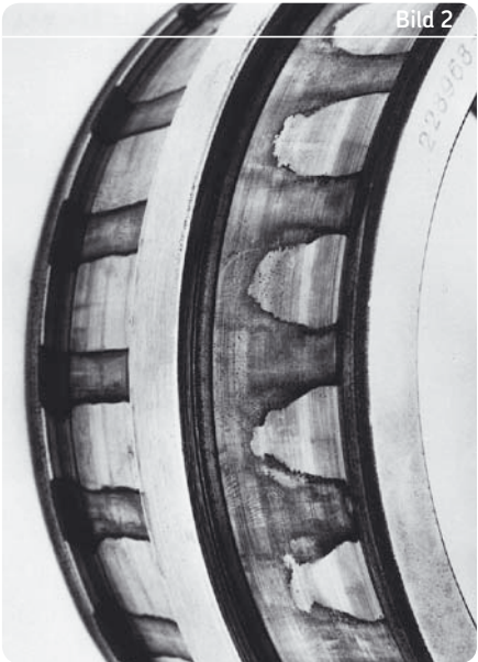
Starke Korrosion infolge Wassereinwirkung (Wasserätzung) auf dem Innenring eines Pendelrollenlagers.
