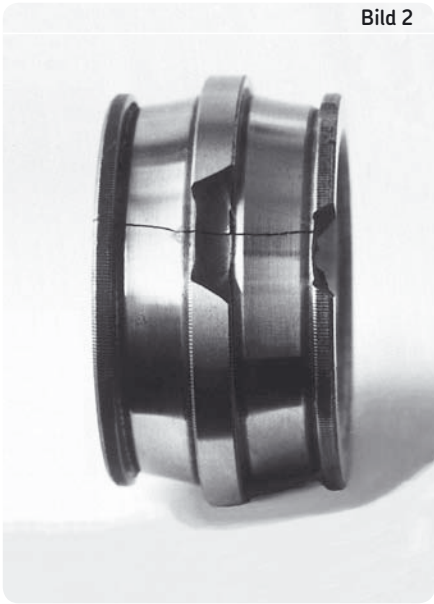
Bild 2: Gerissener Innenring eines Pendelrollenlagers. Zur Inspektion einer Laufbahn (im Bild links) wurde eine Rolle entfernt. Als sie anschließend mit Hammerschlägen wieder eingesetzt wurde, brach ein Teil des mittleren Bords aus. Die Schläge wurden über eine Rolle der rechten Rollenreihe auch auf den rechten Haltebord übertragen, so dass dort ein Stück herausbrach. Gleichzeitig riss der Ring über die gesamte Breite. Bild 3: Innenring eines Pendelrollenlagers mit teilweise abgeplatzttem Haltebord infolge Schlageinwirkung.
