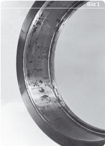
Rostnarben im Außenring eines Zylinderrollenlagers.
