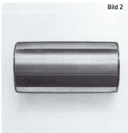
Zylinderrolle mit spiegelblanker Oberfläche infolge Schmierstoffmangel.
