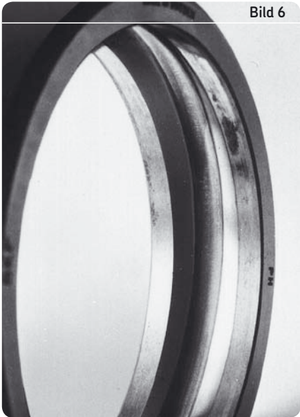
Bild 6: Außenring eines Rillenkugellagers bei Schiefstellung gegenüber der Welle. Die Kugeln sind dabei auf einer ovalen Bahn gelaufen. Dies hat dieselben Auswirkungen wie eine ovale Verformung des Ringes (→ Seite 25).
