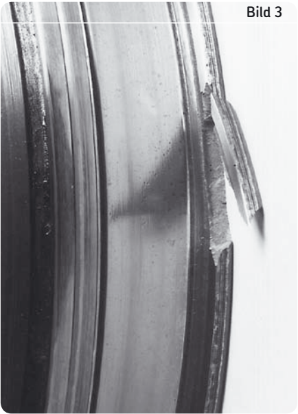
Gerissener Außenring eines Pendelkugellagers. Die Eindrückungen am unteren Laufbahnrand wurden durch unsachgemäße Behandlung verursacht. Der Riss geht von einer dieser Eindrückungen aus.
