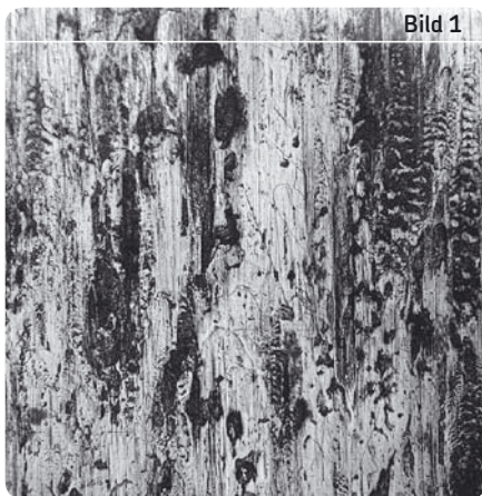
Anschmierungen an der Mantelfläche der Rolle eines Pendelrollenlagers – 100-fache Vergrößerung.
