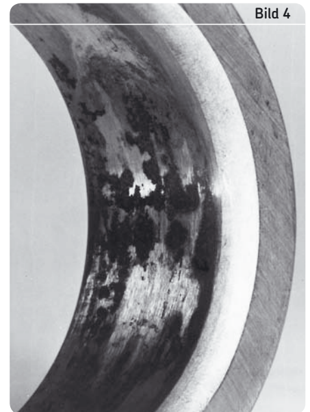
Starker Passungsrost in der Bohrung eines Pendelkugellagers.
